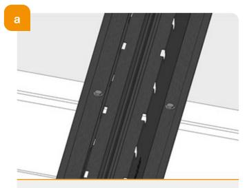
→ Les rails Soprasolar® Park sont fixés à au moins une panne par au moins deux vis autoforreuses pour former un point fixe. Les vis autoforreuses possèdent une rondelle étanche et sont positionnées dans chacune des gorges du rail en respectant le plan d'EXE fourni par Soprasolar®.
