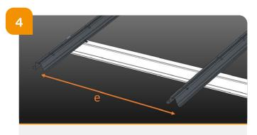
→ Placer le rail suivant à la suite du premier en respectant l'entraxe « e » précisé dans le plan de calepinage (largeur d'un module + 4 mm). L'alignement des rails doit être vérifié au fur et à mesure de la fixation en contrôlant l'entraxe à chaque panne.
