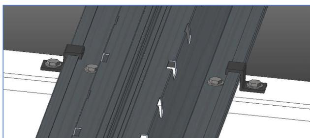
Figure 8 : point fixe de la fixation par crapauds
