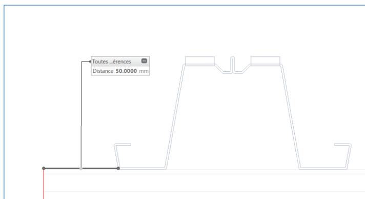
2. Glisser le rail afin d'atteindre le porte-à-faux « p » précisé dans l'EXE. Fixer le rail à chacune des autres pannes en vérifiant l'alignement au fur et à mesure.
