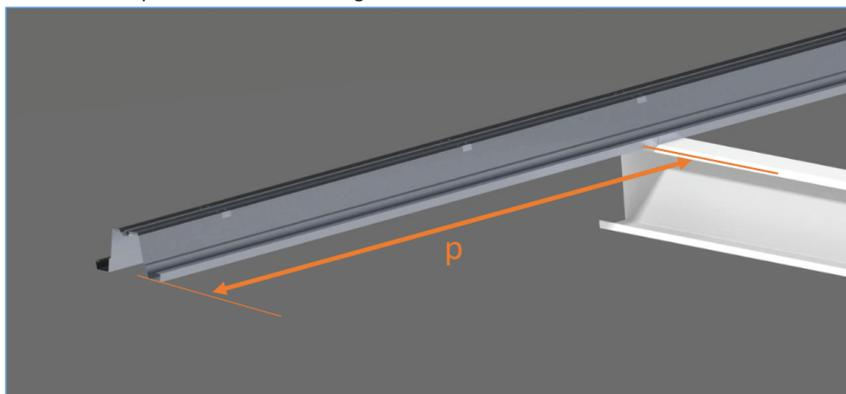
3. Installer un rail temporaire à l'autre extrémité de l'ombrière, à environ 300mm du bord des pannes, selon le même principe que les étapes 1. et 2., en vérifiant bien l'égalité des diagonales avant de le fixer. Tendre un cordeau de position entre les deux parties basses des rails, il permettra de vérifier l'alignement des rails fixés par la suite.
