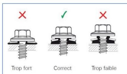
Figure 7 : conformité d'enfoncement de la rondelle d'étanchéité
