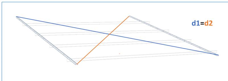
Figure 4 : vérification de l'alignement des rails
