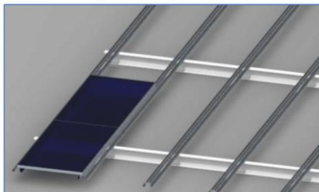
Figure 16 : mise en place d'un second module
