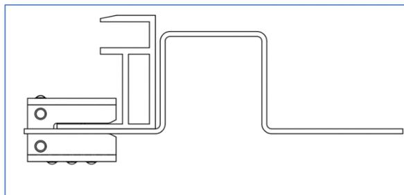
Figure 13 : mise en butée du Soprasolar Clip
