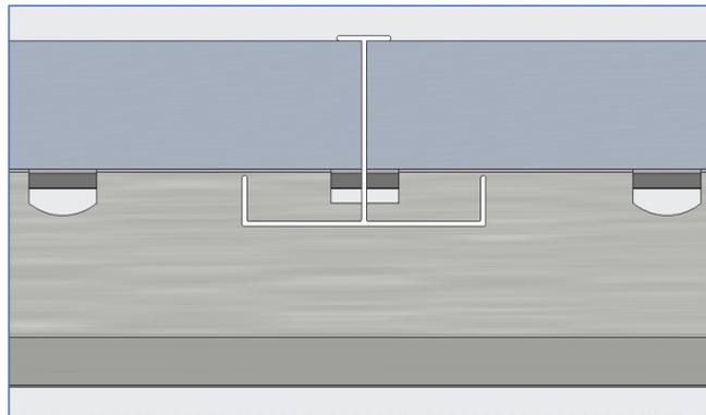
Figure 17: positionnement de la gouttière inter-module entre deux modules
