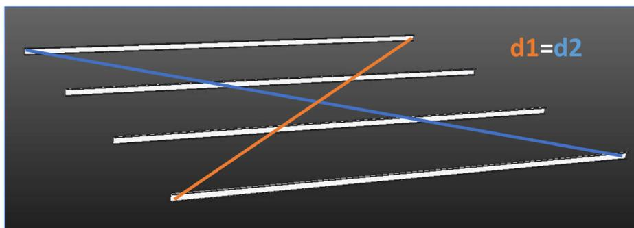
Figure 1 : vérification de l'équerrage de la charpente
